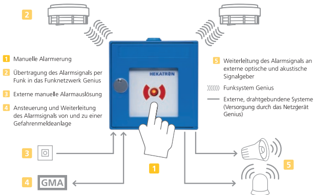
Manueller Hausalarm und vielfältige Schnittstellen in einem Gerät
